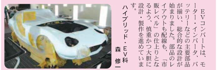
EVコンバートは、モーター・インバータ、バッテリーなどの主要部品が揃い、総合的な設計が始まりました。部品のレイアウトも配線も、「市販レベル」の仕上がりとなるよう、慎重かつ大胆に設計・製作を進めています。
