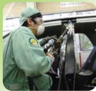
フレーム修正作業
